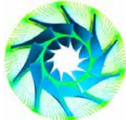
图 13 叶轮 50% 展向速度矢量图
