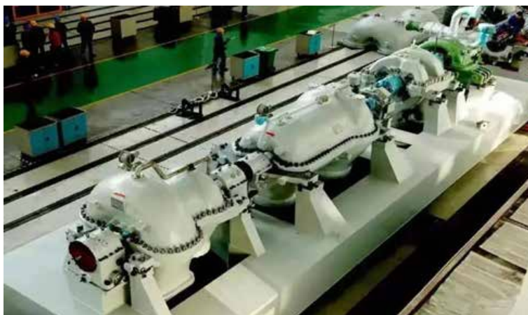
附图1 硝酸四合一机组照片
