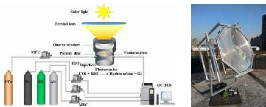
图 3 聚光反应系统原理示意图及真实装置图
